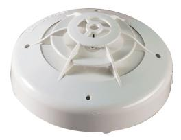
El Detector Analógico de Calor FAH-325 se usa en el circuito de sondeo analógico de la Central de Incendios Compacta FPA-1000-UL. Úselo en interiores con temperatura ambiente alta donde los detectores de humo puedan no ser adecuados debido al vapor o al humo, por ejemplo, en cocinas, salas de calderas o salas de secado. El circuito del termistor lineal es fiable y duradero, y no se ve afectado por los cambios en la humedad, la presión barométrica y el flujo
